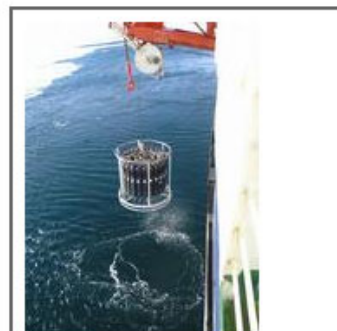
Eine CTD zum Messen von Leitfähigkeit und Temperatur des Wassers in Abhängigkeit von der Tiefe wird von Bord der Polarstern ins Meer
